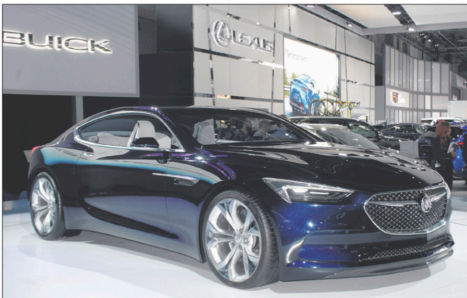
Buick a déjà commercialisé des coupés comme la Riviera et la Grand National. Le concept Avista est basé sur le châssis de la Camaro alors que son V6 biturbo produit 400 ch.
