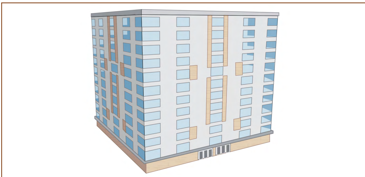
Figure 25 – Exemple d'utilisation de revêtement combustible selon la condition 1.8.2 a) (adaptée de [22])
