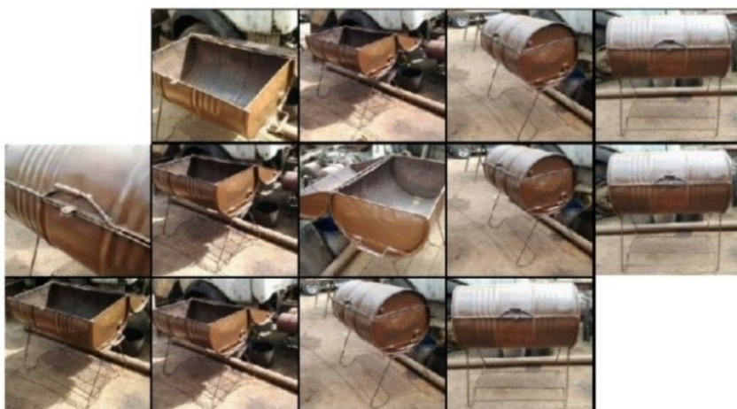
Bacs à ordures domestiques AJDE, fabriqués à partir de fûts vides de 200 L.
