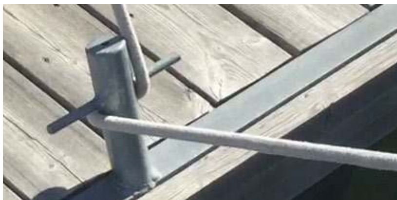
Les équipiers dénouent la traverse en conservant un demi-tour de sécurité au taquet pour maintenir le bateau parallèle au quai.
