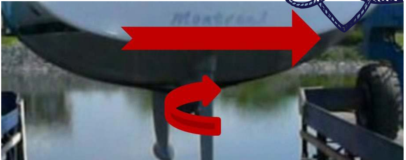
Le pas d'hélice déplace l'arrière du voilier vers la droite lorsque l'hélice tourne dans le sens horaire.
