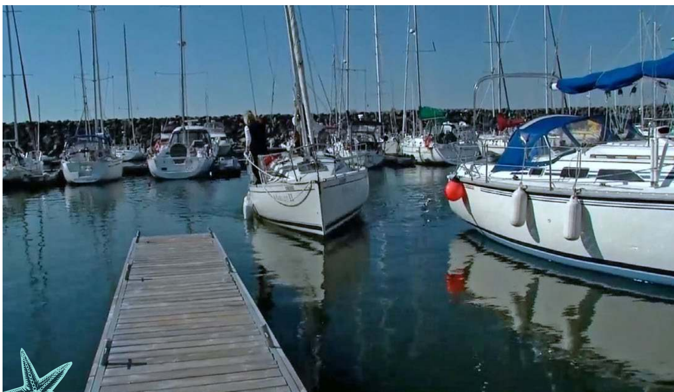
Approcher le quai à vitesse minimale pour rester manœuvrant avec un angle d'environ 20 degrés.
