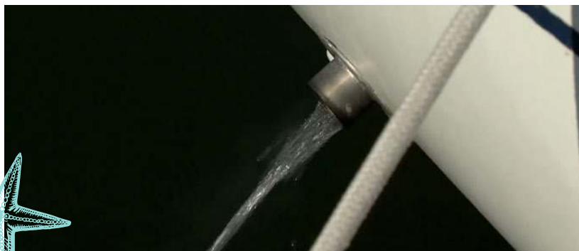
Au démarrage du moteur, si l'eau sort du tuyau d'échappement, c'est que la pompe pour l'eau de refroidissement du moteur fonctionne.
