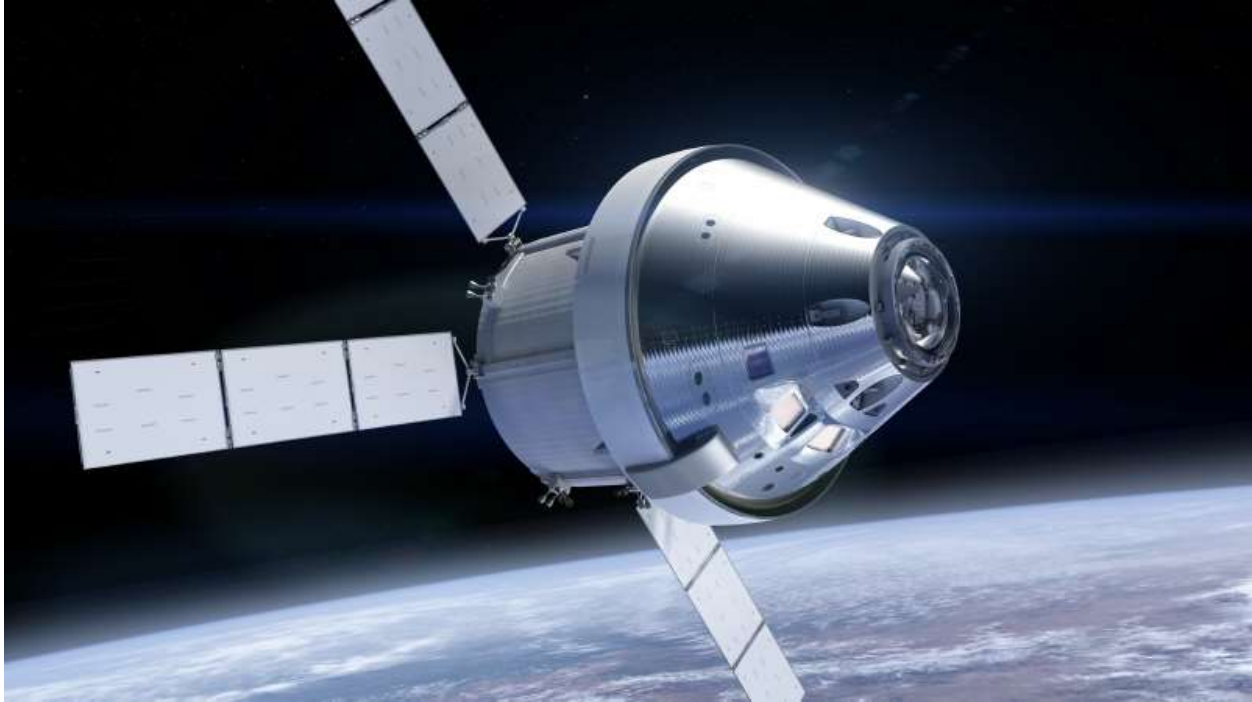
Un vaisseau Orion, composé d'une capsule et d'un module de services muni de panneaux solaires.
