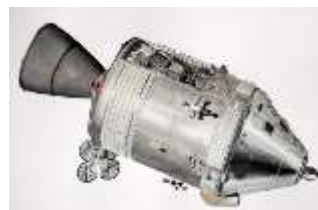
Le vaisseau Apollo, composé d'une capsule de forme conique (à droite), d'un module de services (le cylindre au centre) et terminé par la tuyère du moteur-fusée principal (à gauche).
