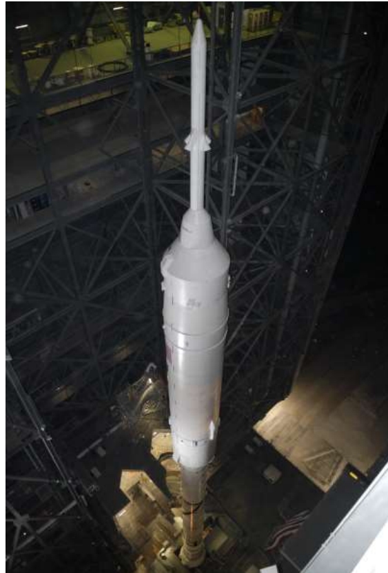
La fusée Ares I-X chapeautée (en blanc) par un deuxième étage, une capsule Orion et une fusée de secours (tous trois inertes).
