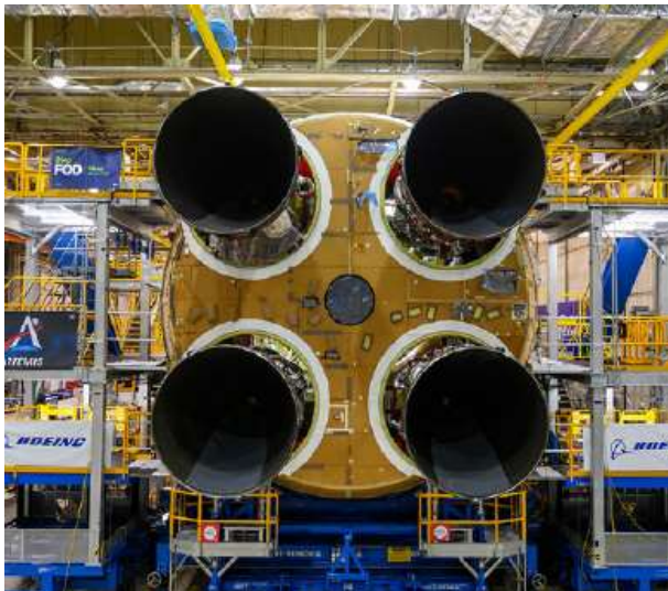
À la base du réservoir central de la fusée SLS, on installe quatre moteurs-fusée SSME qui autrefois équipaient la Navette spatiale.
