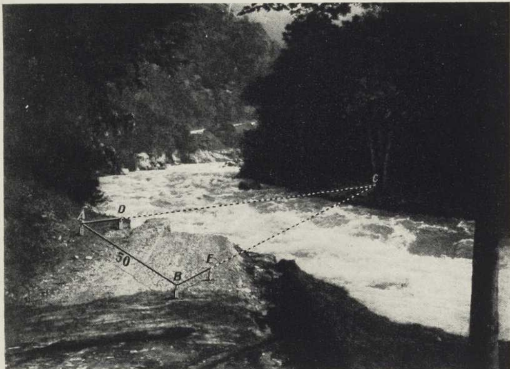
FIG. 33. DISTANCE D'UN POINT INACCESSIBLE.
