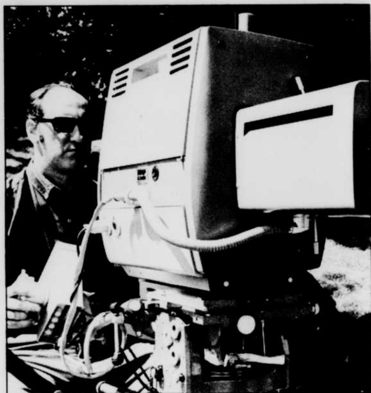
Le cameraman André BRISEBOIS à l'affût. L'aluminium dont elle est revêtue donne à la nouvelle caméra une légèreté qui n'enlève rien à sa solidité. La forme de l'appareil permet l'accès immédiat à tous les éléments et organes du moteur, facilitant du même coup l'entretien de celui-ci.
