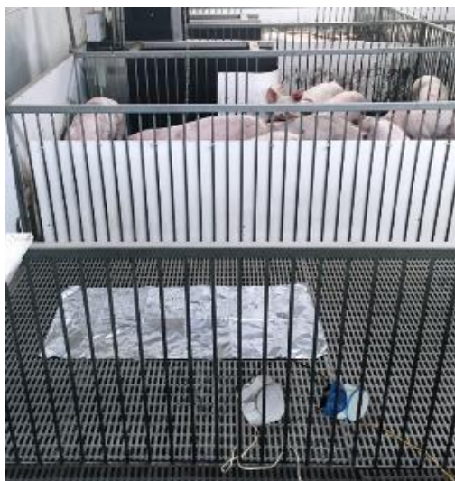
Figure 5 Récolte des aérosols et poussières avec deux XFAN et une feuille d'aluminium dans un parc près des porcs
