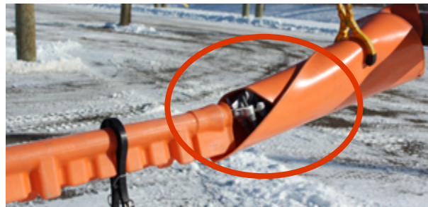
Mauvaise superposition des protecteurs
