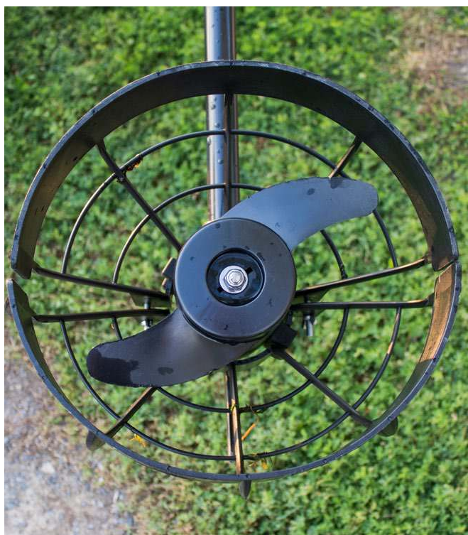
L'hélice est intégrée dans une cage de protection pour éviter les dommages et pour la sécurité des baigneurs.
