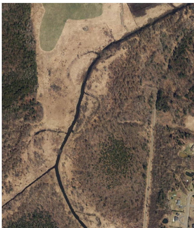
Figure 11. Cours d'eau artificialisé, bassin versant de la rivière Yamaska, avec présence de l'ancien tracé du cours d'eau dans la plaine alluviale
