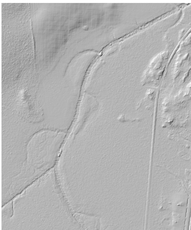
Figure 11. Cours d'eau artificialisé, bassin versant de la rivière Yamaska, avec présence de l'ancien tracé du cours d'eau dans la plaine alluviale
