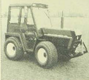
Zetor compact - 4 roues motrices à diesel Perkins de 23 hp
