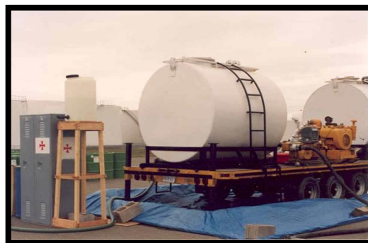
Figure 2.1 Citerne mobile dans un aménagement de rétention
