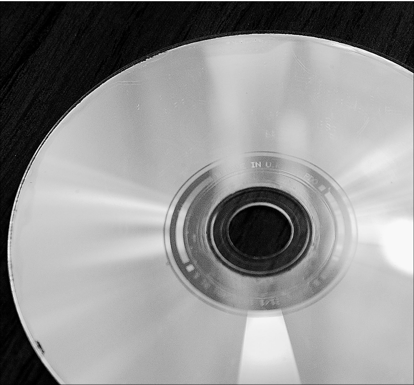
Sur cette photo, on voit assez clairement que la tranche du disque présente des signes de détérioration. Ce CD deviendra rapidement impossible à lire pour le lecteur.
