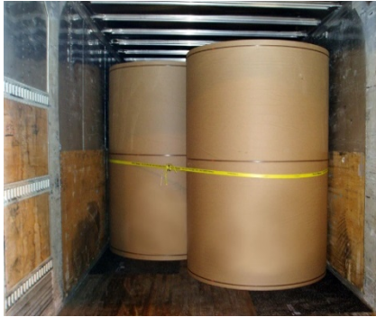
Figure 9 – Des rouleaux de papier cordés dans une boîte de camion-remorque (Pinnacle Systems, www.pinnaclesystems.us/solutions/logistics-planning/karloadr/ Karloadr_1.jpg, page consultée le 13 décembre 2019)
