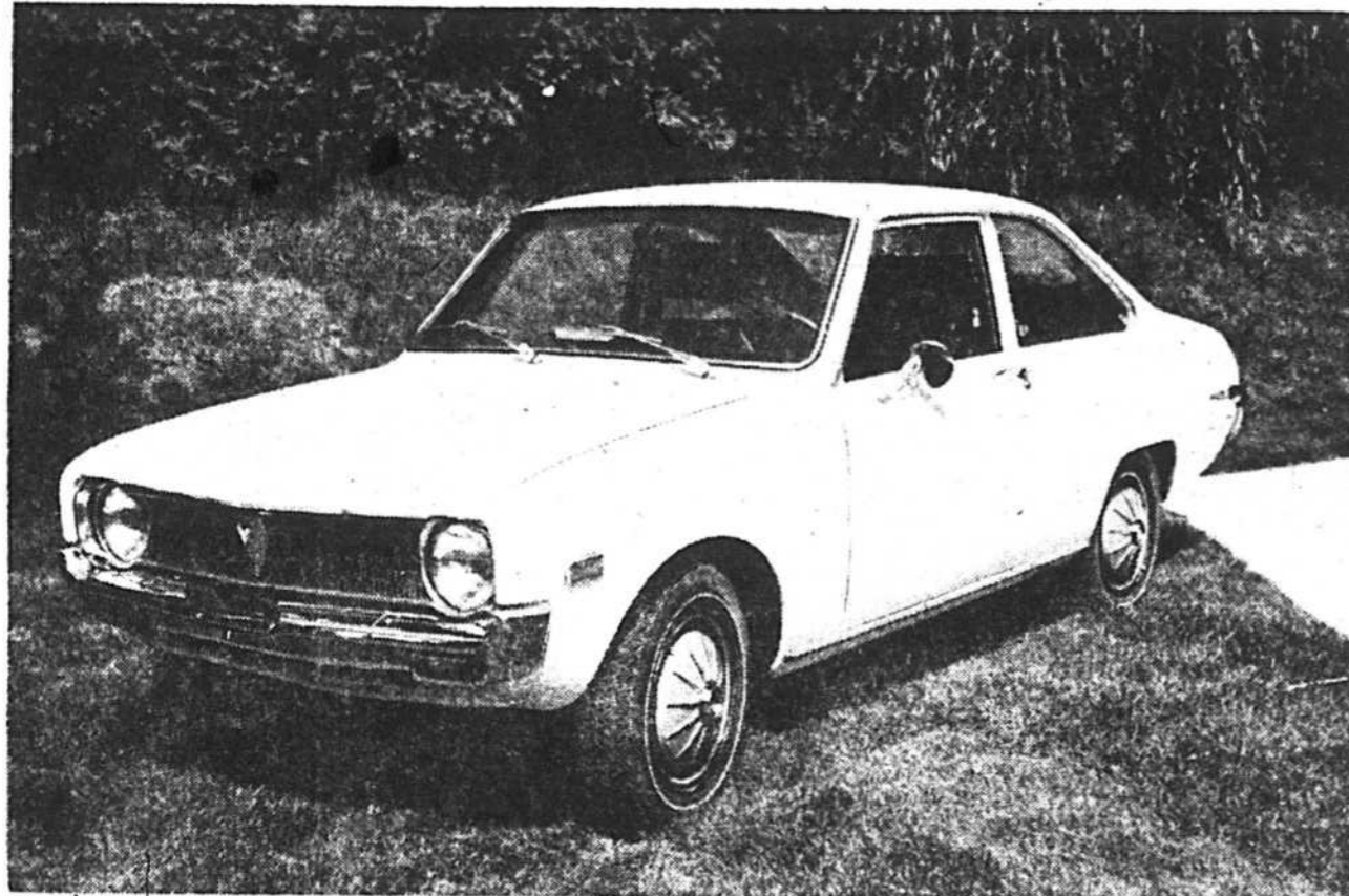
Le coupé rotatif Mazda R-100: 115 m/h avec un moteur de 982 cm.c.
