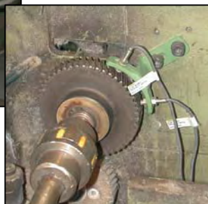
Détail des dispositifs de détection de rotation (détecteurs de proximité inductifs)
