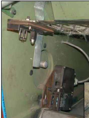
Détail des dispositifs de détection de rotation (détecteurs de proximité inductifs)
