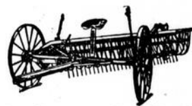
Le râteau de côté McCormick-Deering soulève et aère les andains pour faner le foin. Muni de deux roues glissantes. Fabriqué en deux modèles: pour le foin ou les haricots.
