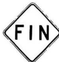
T-40 Fin des travaux
