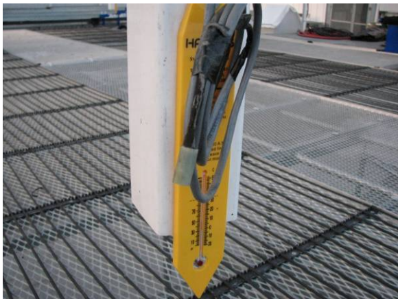
Photo 1 : Sonde qui a été retirée de sa cage. Sur ce modèle, l'extrémité sera retirée et remplacée.
