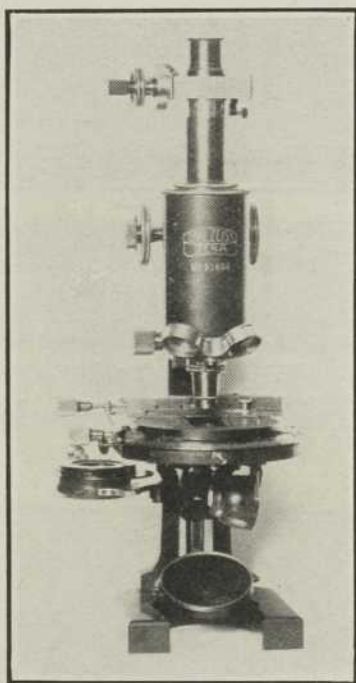
Fig. 24. — Microscope surmonté d'un micromètre oculaire.
