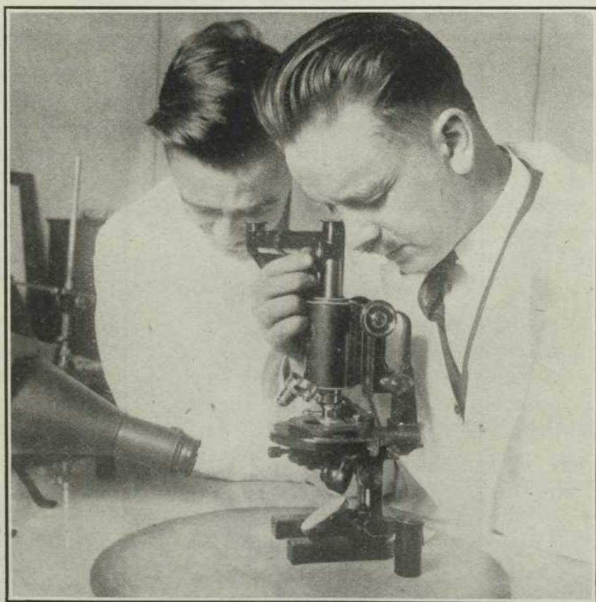
Fig. 33. — Oculaire pour démonstration.
