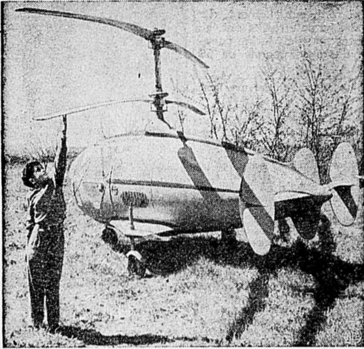
LE PLUS PETIT HELICOPTERE — Cet hélicoptère de fabrication italienne, équipé d'une double hélice et d'un empennage assez extraordinaire, vient de subir avec succès ses premiers essais au-dessus de Rome. Probablement le plus minuscule des appareils de ce genre, l'avion ne pèse que 1,100 livres, est muni d'un moteur de quatre cylindres d'une puissance de quatre-vingts chevaux-vapeur et a un rayon d'action de 400 milles.
