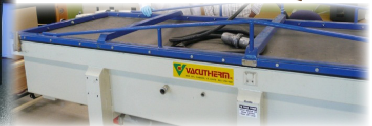
Séchoir sous-vide et sous pression de Vacutherm : diminue le temps et minimise les défauts de séchage
