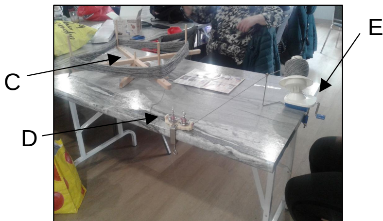
Photo # 2 : Dévidoir (C), tensionneur (D) et enrouleur (E). Source : Luc Carey
