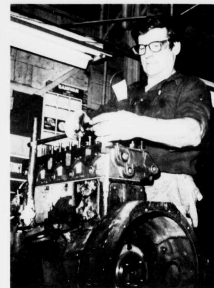
Rosaire Couture, mécanicien, travaille à la remise à neuf d'un moteur de chargeur à benne, au garage des Services d'appui technique.
