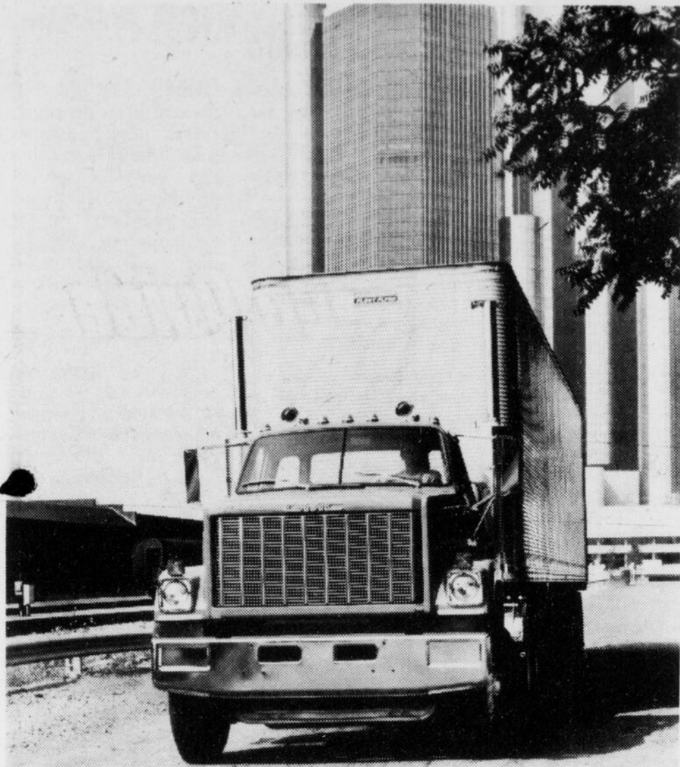
Le Brigadier 1979, un poids lourd GMC à cabine classique courte, comprend un capot en fibre de verre moulée, basculant vers l'avant de 90 degrés pour faciliter l'accès au moteur. Le nouveau compartiment standard à batteries, rigide et anticorrosion, donne une garde au sol plus grande, réduit les exigences d'entretien et facilite l'entrée dans la cabine.
