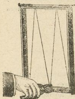
Fig. 46. — Manière de tendre les fils de fer sur un cadre.
