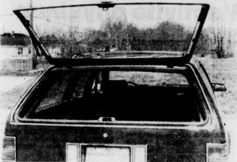
Caractéristique intéressante de la portière arrière, on peut ouvrir soit la vitre seule...
