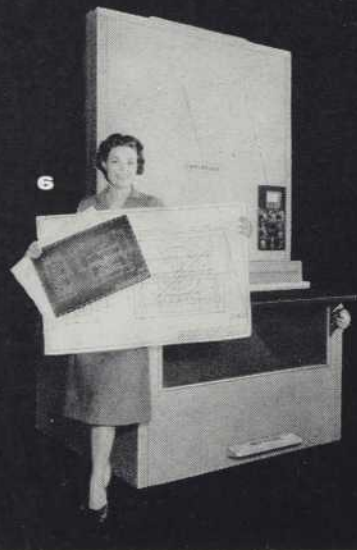
Caméra de reproduction réduite Revolute — Transparences de format réduit effectuées directement des dessins originaux pour reproduction instantanée, avec l'appareil de photo-calque ou de type diazo.
