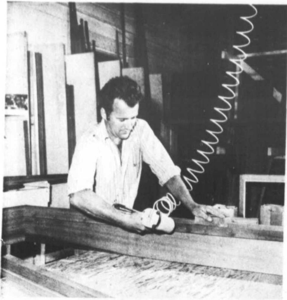
Roland Mailhot, travaillant sur la pose des moulures dans les boîtes de chassis.
