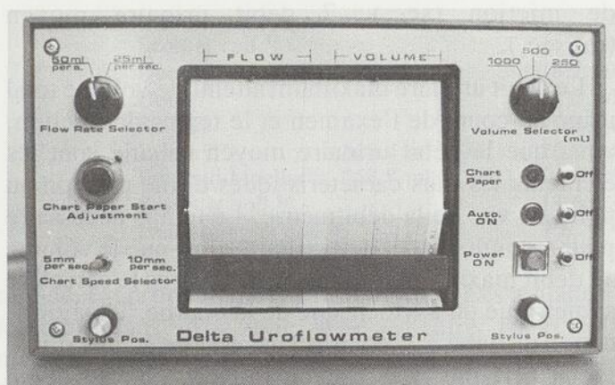
Fig. 1 (b) — L'enregistreuse à deux canaux avec ses boutons de sélection et ses leviers de commande, placée à distance du débitmètre, de préférence dans une pièce voisine, pour assurer l'intimité du malade pendant la miction.
