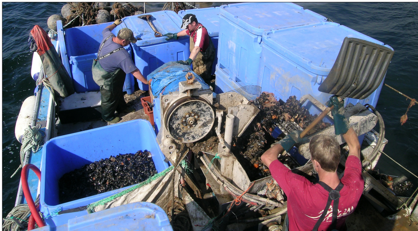
Figure 1a. Vue en plongée du système de récolte standard avec convoyeur et dégrappeuse-trieuse à bord du GRT-Symbiose .
