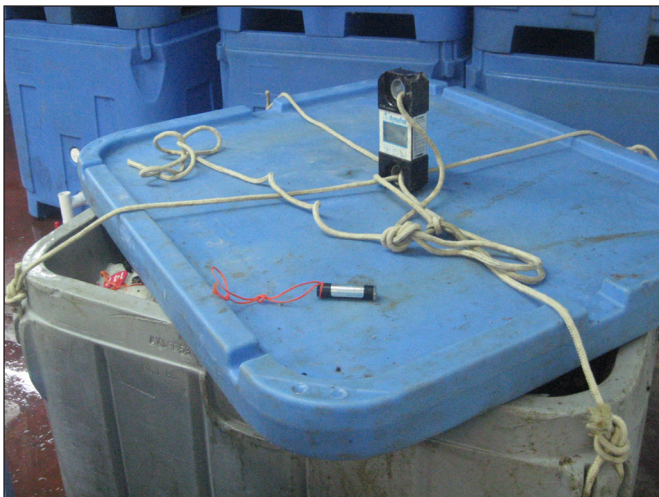
Figure 9. Le tensiomètre utilisé pour mesurer le poids des bacs isothermes avec et sans leur contenu de moules.
