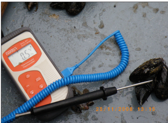
Figure 4. Thermomètres numériques Oakton 00702-75 ou Barnant 100 modèle 600-2820 munis chacun d'un thermocouple P161- SENSE 08500-65 de type T pour mesurer la température à cœur des moules.
