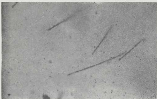
Fig. 5. Dans le détecteur ionographique, particules alpha (traces plus opaques), et protons (traces plus pâles).
