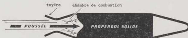
Fig. 2. Propulsion chimique avec propergol solide.
