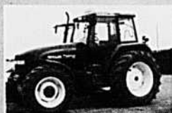
New Holland TM 115, transmission 18/6, 4x4, 4 sorties d'huile, 2001.
