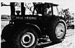
Ford 8630, transmission 18/6 automatique, 6 cylindres de 401 p. c.
