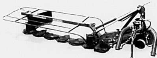
Faucheuses à disques trois points, largeur de 1.65 à 3.2 mètres
