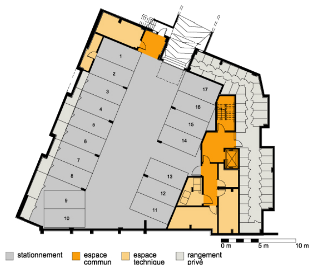
Figure 49 : Plans du sous-sol
