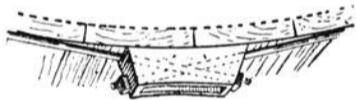
Fig. 8—Couplure (clip) en bois ou en fer qu'on emploie si l'on ne laisse point de poteaux dans les parois.
