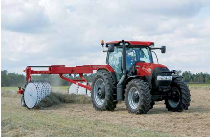
Le Maxxum 150 de Case IH a deux cylindres additionnels qui permettent plus de couple.
