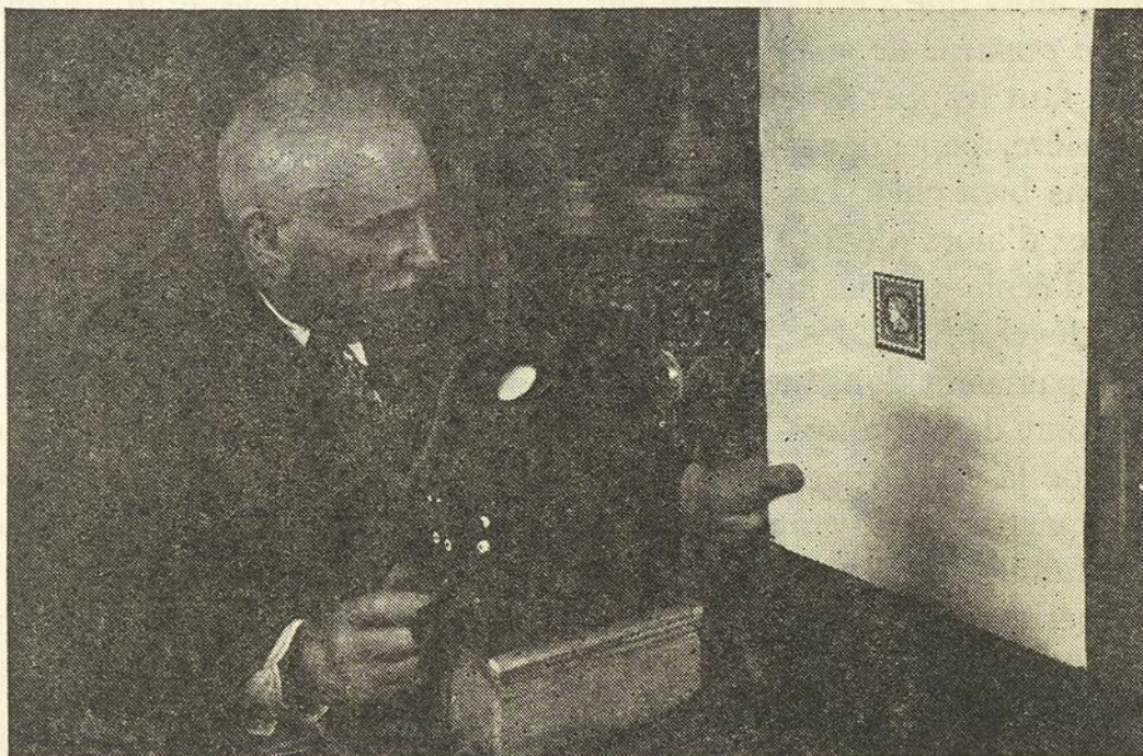
L'auteur de l'article, M. Jacques Boyer, observant un timbre au « Radar » de projection dans une demi-obscurité. L'image agrandie du timbre apparaît sur un écran blanc fluorescent
