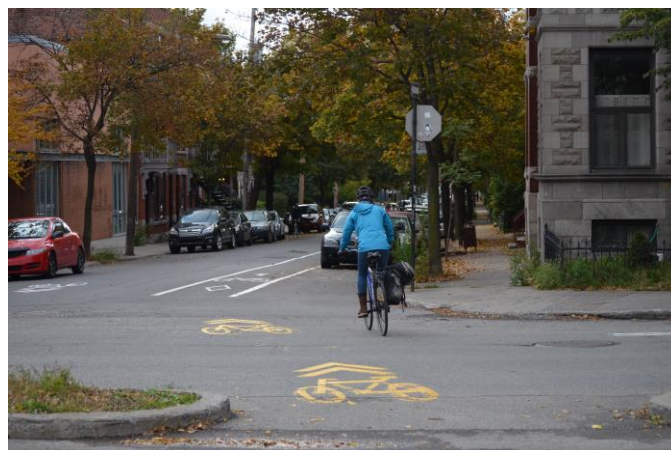
Figure 3 - Terre-plein traversant la chaussée, ce qui permet la traversée des cyclistes, mais empêche le passage des véhicules routiers
