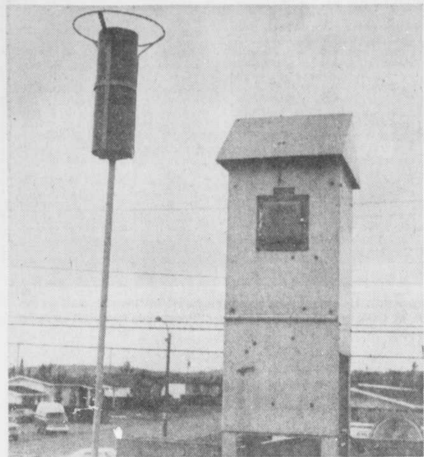
Une station de repérage comprend un échantillonneur à grand volume (à droite), et une jauge des retombées dont le bout est exposé à l'air ambiant.
