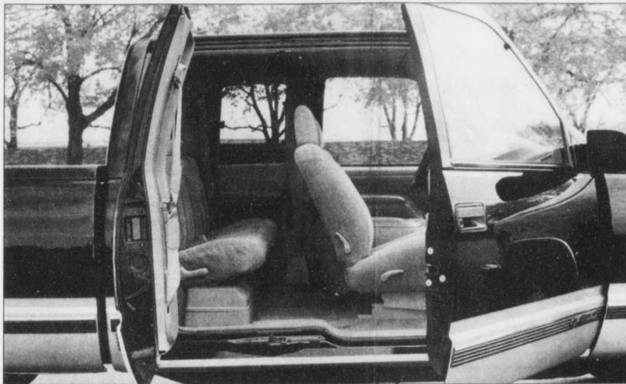
Le plus apparent des changements apportés aux camionnettes Chevrolet, c'est l'addition d'une troisième portière à la cabine allongée pour donner libre accès soit à des passagers ou des marchandises à l'arrière des sièges. Elle est située du côté conducteur dans la compacte Sonoma et du côté passager dans la série des camionnettes de grande taille C/K.
