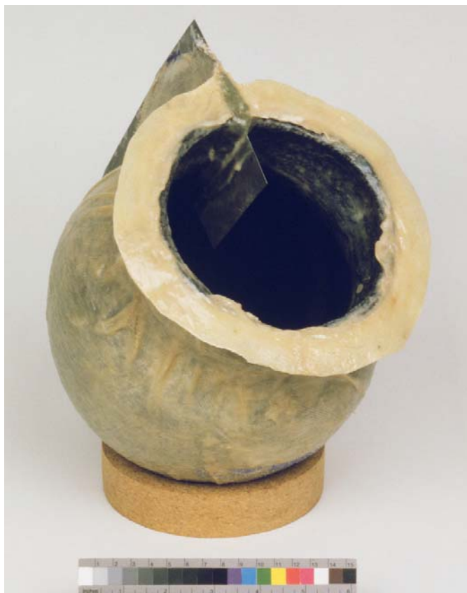
Figure 28 : Vue de l'objet recouvert de latex avec le séparateur métallique en place.
