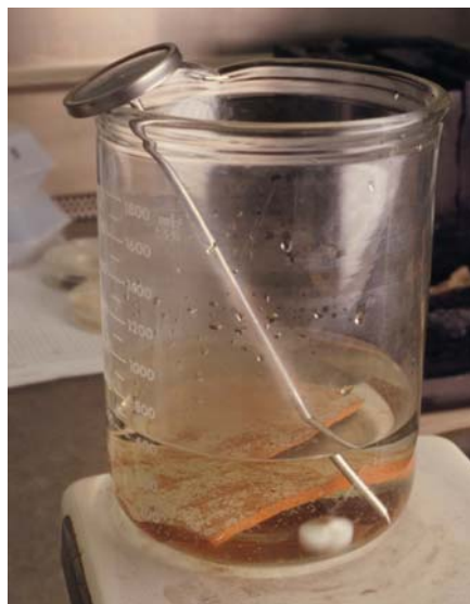
Figure 96 : Le traitement chimique d'un tesson provenant du Elizabeth and Mary . Un agitateur assure une bonne dispersion du complexant et un thermomètre permet la vérification de la température de traitement. Photographie : Centre de conservation du Québec, André Bergeron.
