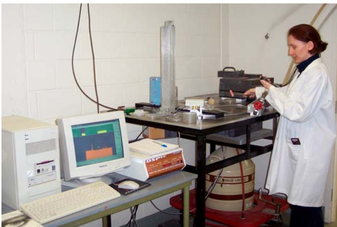
Figure 21 : La composition chimique de tessons de céramique est mesurée en suivant la méthode d'analyse par activation neutronique. Après l'activation par les neutrons du réacteur nucléaire, l'échantillon de céramique est placé dans un spectromètre pour la détection des rayons gamma. Dans le spectre, les pics de tous les éléments présents dans l'échantillon sont bien visibles.
