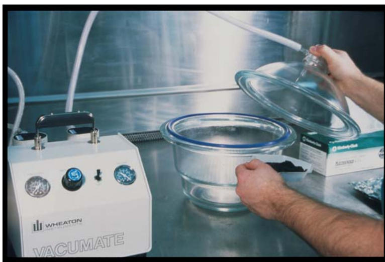
Figure 5 : Vue de la cloche de consolidation avec la pompe à vide. Photographie : Cinémanima, Michel Tremblay.
