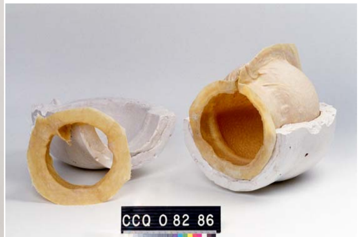
Figure 29 : Vue du moule avec les principales sections démontées.
