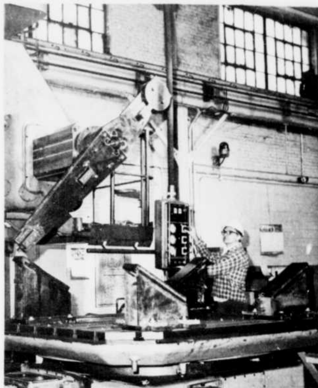
M. Jean-Roch Plourde, machiniste à l'atelier d'usinage actionne le bras-outil de l'aléuseuse qui servira à centrer les supports des paliers-guides.
