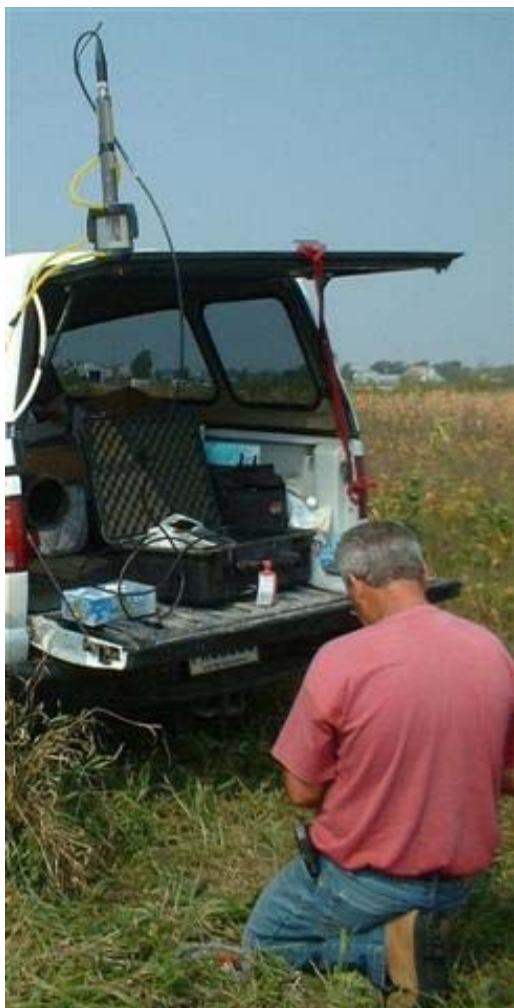
Photo 8. Mesure des paramètres physicochimiques. La cellule de mesure se trouve sur le toit de la voiture (MDDEP, 2010)
