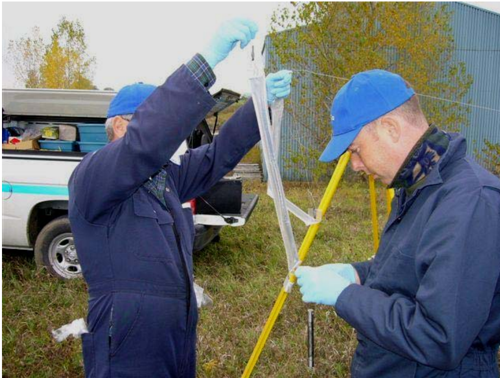
Photo 9. Exemple d'échantillonneurs passifs : sacs à diffusion (MDDEP, 2008)
