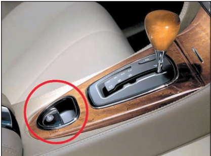
Ne cherchez plus le levier du frein d'urgence. Il a été remplacé par une discrète commande nickelée qui se trouve juste devant l'accoudoir central.
