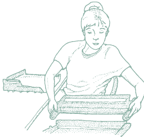
Fig. 4.5 Aperçu du réaménagement prévu par l'entreprise. Notez la torsion du dos lors du dépôt du cabaret.
