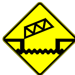
Figure 14.1-10 D-410 – Signal avancé d'un pont-levis
