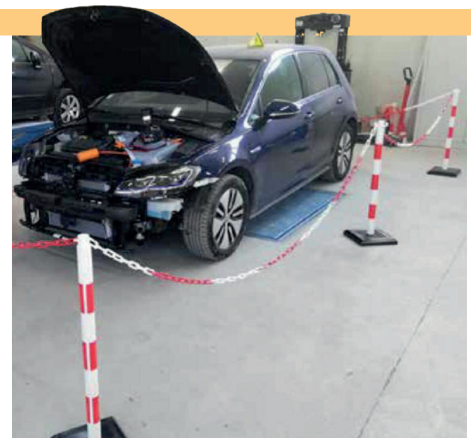
Établir une zone sécurisée est nécessaire.
