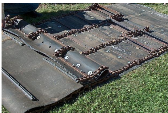
Figure 11-7. Tapis de caoutchouc à installer entre les lattes et les chaînes du convoyeur d'alimentation.
