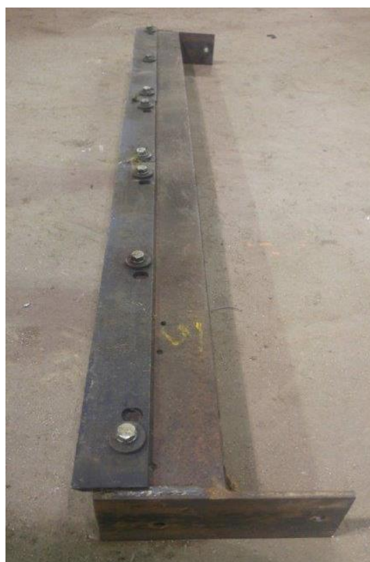
Figure 11-10. Couteau stationnaire pour le tire-paille – vue latérale.
