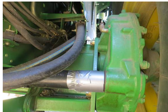
Figure 11-17. Exemple de composante bénéficiant de l'utilisation de duct tape comme protection.
