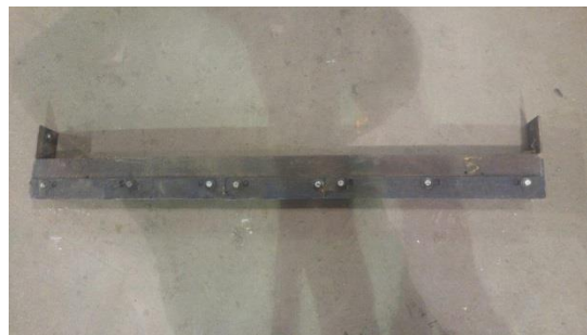
Figure 11-9. Couteau stationnaire pour le tire-paille – vue de dessus.
