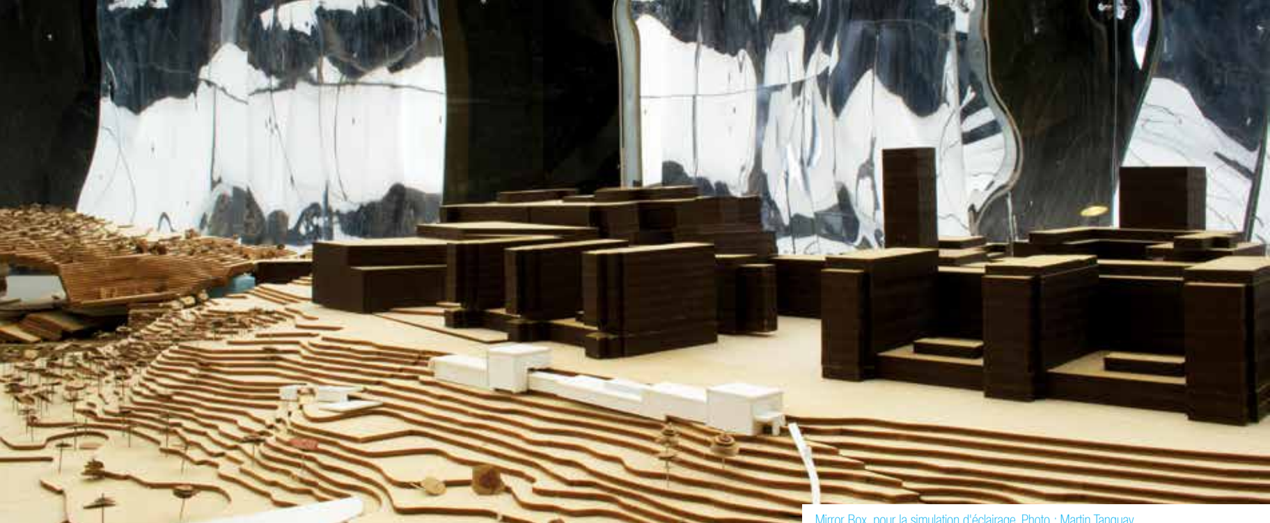
Mirror Box, pour la simulation d'éclairage. Photo : Martin Tanguay.
